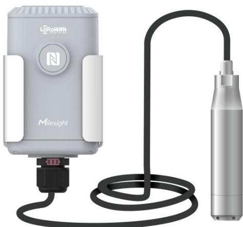
EM500-SWL 传感器是一款设计简约美观、功能强大的投入式液位传感器。EM500-SWL 传感器采用专用传感器调理电路，结合先进的压阻式压力变送器设计制造技术，能够实时监测液位，并通过无线 LoRaWAN® 通信技术传输到远程平台。
