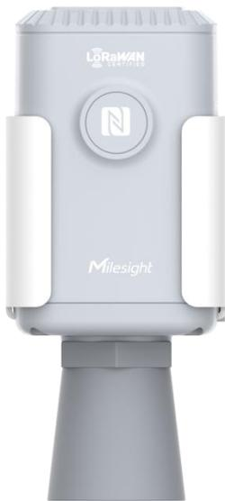
EM500-UDL 传感器是一款设计简约美观、功能强大的超声波测距传感器。EM500-UDL 传感器采用超声波回波测距原理，使用精确的时差测量技术检测传感器与目标间的距离，并通过无线 LoRaWAN<sup>®</sup>通信技术传输到远程平台。
