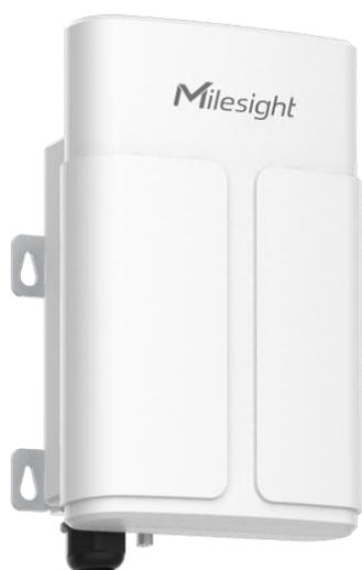
UG67 是一款基于 LoRa® 低功耗广域网技术的室外物联网网关，设备内置 Semtech 高性能 8 通道收发器 SX1302 芯片，支持全双工模式和上千个终端节点接入网关。并采用 IP67 防水防尘外壳；内置超级电容，支持异常断电下短时间运行并告警，满足各种户外复杂环境的 LoRa® 网络覆盖。
