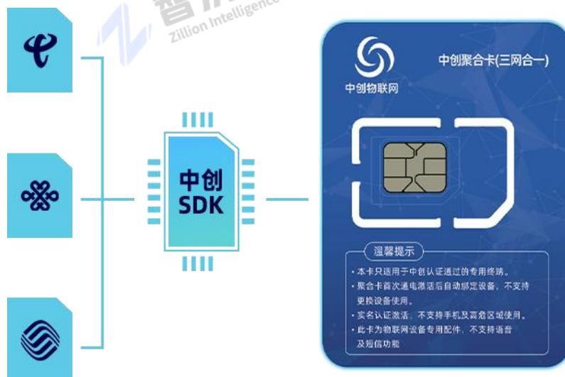
通过技术手段集成三大运营商的 SIM 卡，合规无风险，实现多网络备份增加网络连接的可靠性从 99.76%提升到 99.99%，主动或被动选择最优信号的运营商进行接入，保证设备实时在线，全面的支持 2/3/4/5G 网络、支持插拔跟贴片多种形态，满足不同应用场景。
