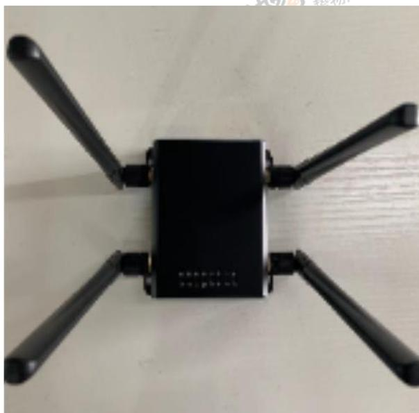
采用中创聚合技术，为物联网客户提供三网智能切换的聚合产品，支持本地策略设置，支持外插 Sim 卡，支持云端策略，支持远程运维，一站式解决客户联网需求；1、免插卡；即插即用，2、电信、联通、移动智能切换；3、智能策略，省钱、省事、省时间；4、无线有线多线路备份；5、LTE Cat4 全程高速保障；6、300M、1200M 多重选择；
