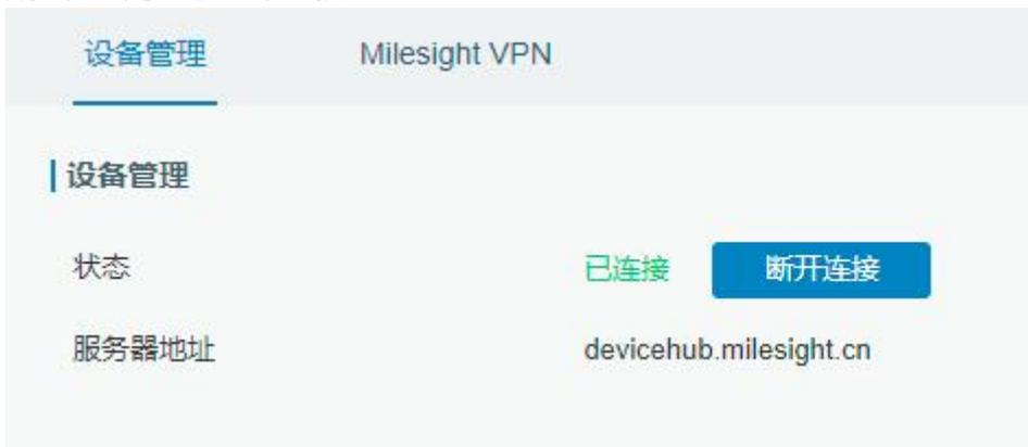
4. 连接的设备出现在设备管理系统上，状态显示为●，说明设备已连接成功，系统可以对该设备进行管理。
