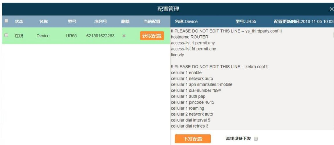
3. **UG 系列网关**: 点击“选择文件”，上传网关.dat 格式的配置文件（可在网关的“维护” → “备份还原”页面，备份网关的配置文件，**注**：设备管理系统仅支持导入批量备份文件）。文件上传成功后，单击“保存”将配置文件下发批量部署到已选择的设备。如果需要配置离线设备，勾选“离线设备下发”，设备管理系统将在设备上线后完成配置。
