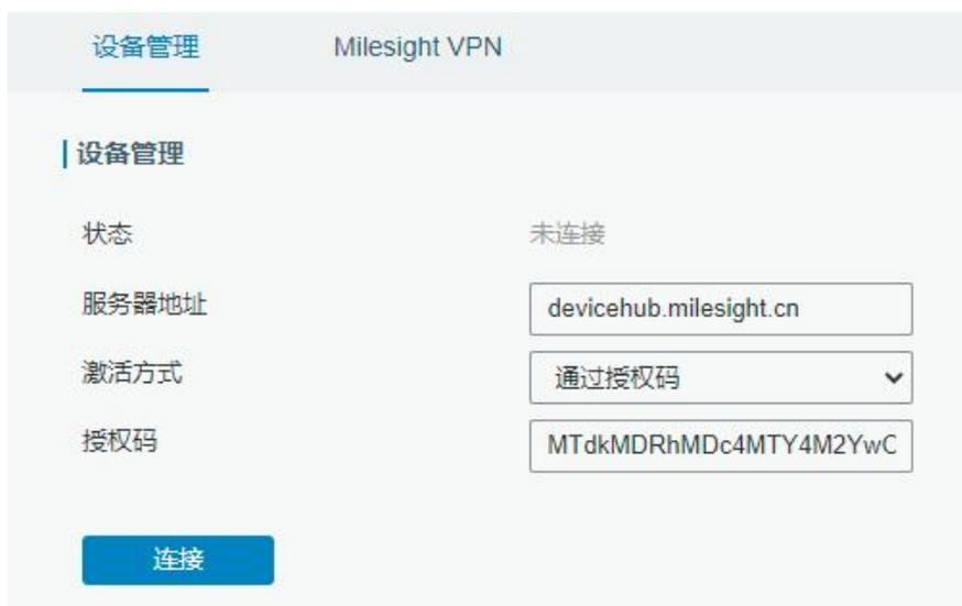
7. 点击“连接”，如果授权码正确，状态栏将显示“已连接”。
