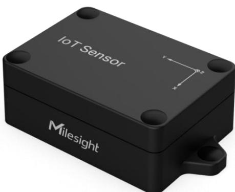
EM310-TILT 是一款稳定可靠的 LoRaWAN® 倾斜传感器，产品内置 MEMS 三轴加速度计，能够精准计算 X/Y/Z 三轴角度偏移量，可用于倾角测量或物体运动测量等场景。此外，产品支持阈值告警，可自定义设置 X/Y/Z 三轴多种组合关系告警，满足复杂角度监控需求。
