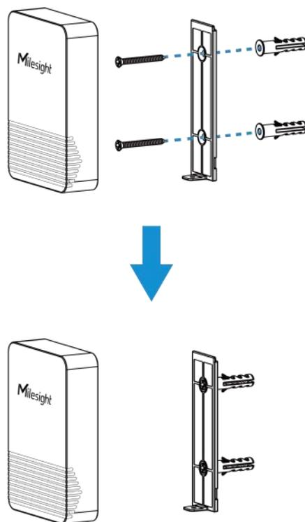
2. 将设备对准安装板，垂直向下扣紧，用 1 颗 M2 固定螺丝将设备底部和安装板固定在一起。（如需取下设备，请先拧下设备底部的固定螺丝，将设备向上抬起后取下）
