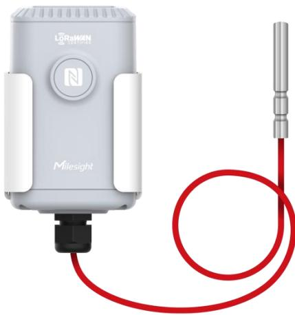
EM500-PT100 传感器是一款设计简约美观、功能强大的温度传感器。EM500-PT100 传感器采用高精度铂热电阻元件，支持从-200°C 到 800°C 的高温度测量的可选范围，并通过无线 LoRaWAN<sup>®</sup>通信技术传输到远程平台。
