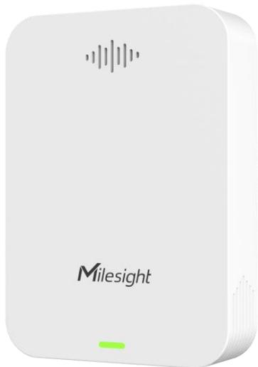
星纵物联 GS301 是一款四合一卫生间异味传感器。产品内置高性能探测元件，采用电化学原理，灵敏地检测空气中氨气 (NH<sub>3</sub>)、硫化氢 (H<sub>2</sub>S) 两种气体浓度是否超标，同时产品内置温湿度探头，有效感知周边环境温湿度变化。当检测气体浓度超出设定值，GS301 会触发本地声光报警，并及时告警到平台端。
