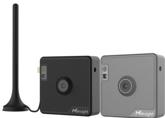
星纵物联 SC541/SC541-C1 是一款智能小巧的 AIoT 感知相机，采用 1920×1080 高分辨率镜头搭配一颗小型补光灯，能够稳定获取高质量图片并传输至管理平台。此外，产品支持 4 种抓图模式，全方位满足您的不同抓图需求。
