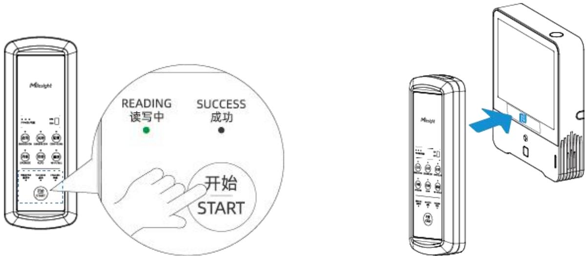
**注意：**当“读写中”指示灯由闪烁变为常亮时，表示 SCT01 正在写入节点设备，请保持两台设备**静止贴紧**以避免写入失败。星纵物联终端节点设备的默认配置密码是 123456。如果终端节点设备使用不同的密码，请在执行任何操作之前，通过 ToolBox App 连接 SCT01 并写入终端节点设备配置密码。
