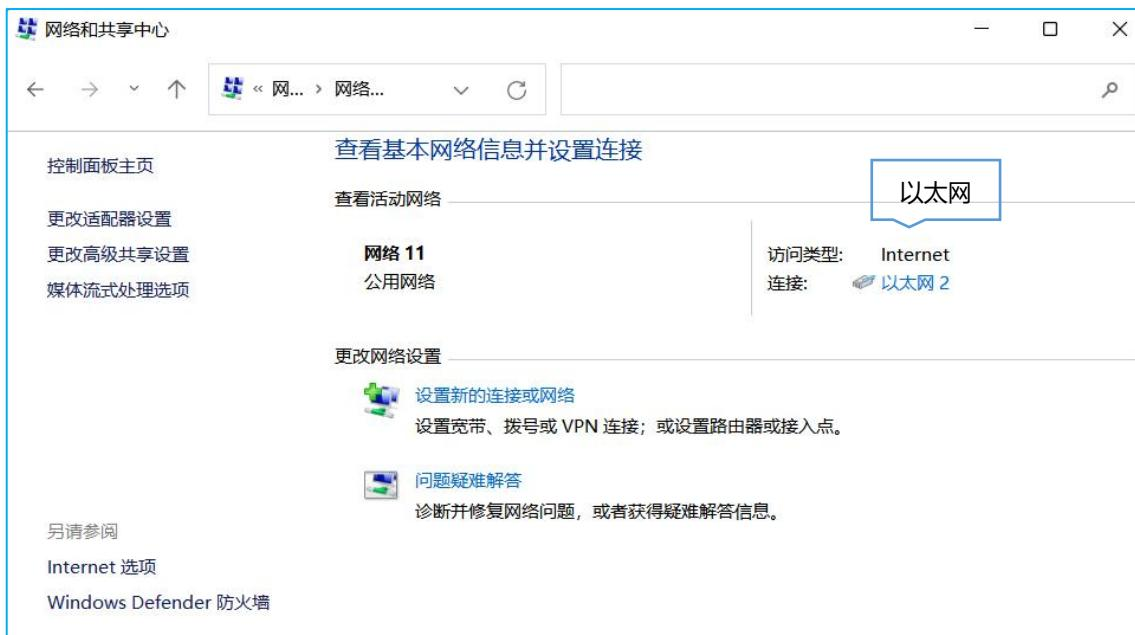
3. 进入“属性” -> “Internet 协议版本 4 (TCP/IPv4)” 页面后，选择“使用下面的 IP 地址”，手动配置一个与网关子网相同的 IP 地址。
