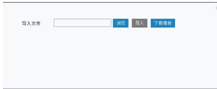
点击“下载模板”后按模板的格式添加节点设备，application，deviceprofile 与前面配置的参数一致，其余参数根据终端是 OTAA 还是 ABP 进行添加。编辑完成后，点击“浏览”上传文件。
