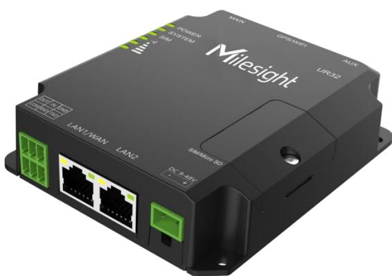
UR32 是一款精致小巧、性价比高的 4G 路由器。强大的硬件设计结合丰富的软件特性使 UR32 能胜任各式各样的物联网 /M2M 应用。UR32 支持以太网、Wi-Fi、4G 蜂窝等多种网络接入方式和多重链路备份功能，为数据传输提供稳定可靠的网络环境。
