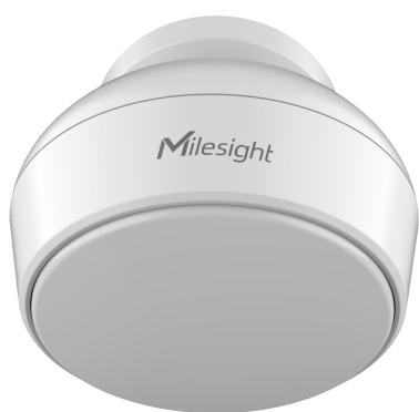
VS370 是一款精致小巧的智能传感器，专为会议室占用检测和微动人体存在感知而设计。产品通过雷达+PIR 双重检测技术，实时感知会议室的使用状态。同时，产品还内置了光照传感器，可结合室内实际的光照强度共同实现智能探测和场景联动。此外，产品内置 2 节 2700 毫安时锂亚电池，可连续使用数年无需更换，且电池仓通过旋转卡扣开合，电池更换便捷，有效降低维护成本。
